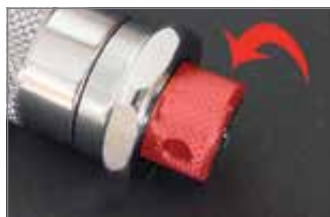
3. Insurubati la loc surubul de la baza pentru a fixa ajustarea cuplului.
