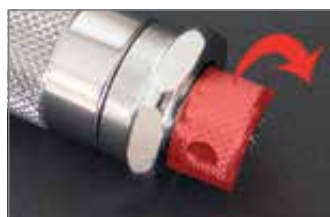
1. Desurubati surubul de la baza ca sa eliberati surubul pentru ajustarea cuplului de strangere
